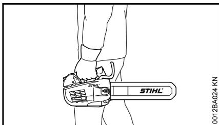
Toujours porter la tronçonneuse seulement par la poignée de commande – le silencieux très chaud étant tourné du côté opposé au corps – et le guide-chaîne étant orienté vers l'arrière. Ne pas toucher aux parties très chaudes de la machine, tout spécialement à la surface du silencieux – risque de brûlure !
