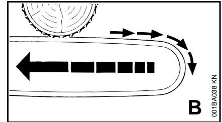
Si lorsqu'on coupe avec le côté supérieur du guide-chaîne – coupe par le dessous – la chaîne coince ou touche un corps étranger noyé dans le bois, la tronçonneuse peut être repoussée en arrière, en direction de l'utilisateur – **pour éviter ce phénomène :**
