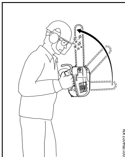
En cas de rebond (kick-back), la tronçonneuse est brusquement projetée vers l'utilisateur en décrivant un mouvement incontrôlable.
