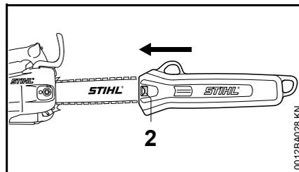
Toujours pousser le protège-chaîne à fond sur le guide-chaîne. L'ergot (2) doit s'encliqueter sur le couvercle de pignon.
