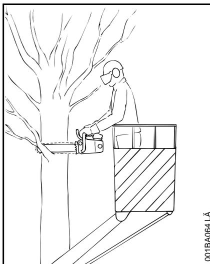
Si les conditions le permettent, travailler de préférence à partir d'une **nacelle élévatrice**.
