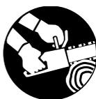
**Tenir fermement la tronçonneuse à deux mains – grand risque d'accident :** main droite sur la poignée de commande – ceci est également valable pour les gauchers. Pour pouvoir guider la machine en toute sécurité, empoigner fermement la poignée tubulaire et la poignée de commande en les entourant avec les pouces.
