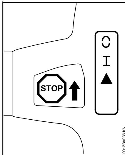
**STOP** ou ☺ – pour couper le contact, il faut pousser le levier de commande universel en direction de **STOP** ou ☺. Lorsqu'on le relâche, le levier de commande universel revient en position **I**, sous l'effet de son ressort.
