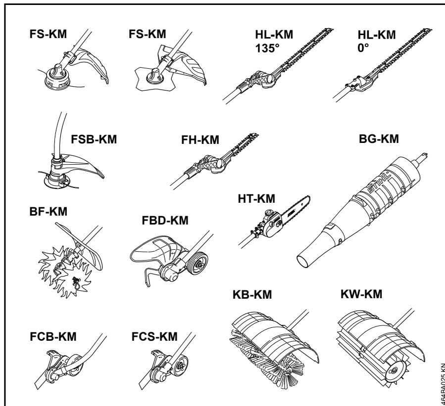
Sur le moteur CombiSystème, le montage des outils CombiSystème STIHL suivants est autorisé :
