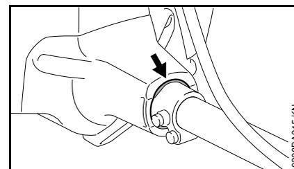
Un élément en caoutchouc amortissant les vibrations est intercalé entre l'ensemble moteur et le tube. Les faire vérifier s'ils présentent des traces d'usure visibles ou si une élévation permanente du taux de vibrations devient perceptible.
