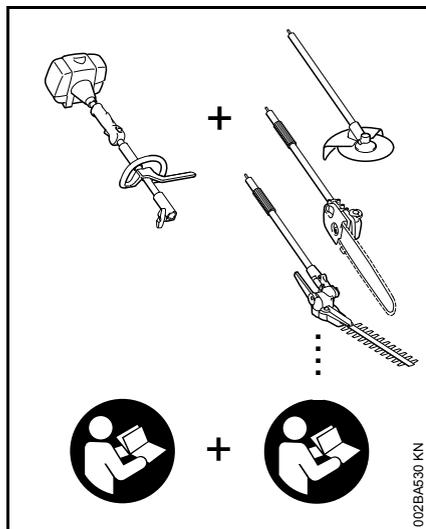
Le CombiSystème STIHL offre la possibilité de combiner différents moteurs CombiSystème et outils CombiSystème pour composer un dispositif à moteur complet. Dans la présente Notice d'emploi, l'ensemble – en ordre de marche – d'un moteur CombiSystème et d'un outil CombiSystème est dénommé dispositif à moteur ou machine.
