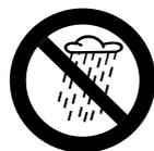
Ne pas travailler avec la machine sous la pluie, à un endroit mouillé ou dans une ambiance très humide – le moteur électrique n'est pas protégé contre la pénétration de l'eau.
