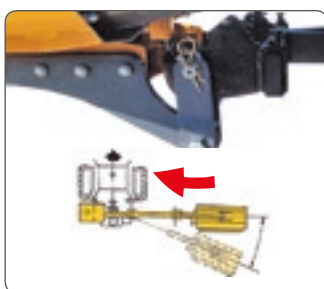
Ammortizzatore meccanico (salvaguardia bracci in caso di ostacoli). Mechanical breakerway (protection in the event of obstacles).
