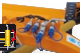
Vanne pour blocage hydraulique du groupe de broyage (pour transport).
