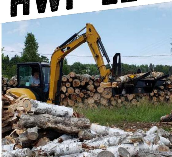
Le HWP-120 est conçu pour le propriétaire qui coupe entre 10-20 cordons par an et est construit en acier 1/4". Vous pouvez traiter jusqu'à 1.5 cordons par heure. Nous proposons deux modèles du HWP-120: un coin fixe à 4 voies où avec un cale réglable à 6 positions. Poids: 975 livres
