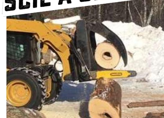
Notre scie à grappin est parfaite pour les chaudières extérieures ou pour le nettoyage des tempêtes, permettant à la chargeuse compacte et à la scie à grappin de faire tout le travail! Le grappin ouvre 48" et peut déplacer et couper de grosses bûches (28"+) qui ne rentrent pas dans nos processeurs. Poids: 770 livres
