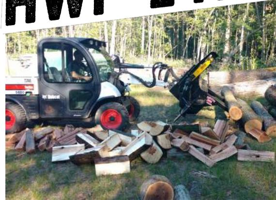
HWP-140B est le produit phare de la gamme Halverson et coupe des bûches jusqu'à 18". Il est construit en acier 3/8" et conçu pour ceux qui coupent plus de 100-200 câbles par an. Vous pouvez traiter 1,5 à 2 cordons par heure. Il est livré en standard avec une cale réglable en 4 directions. Le coin de fendage à 6 voies est disponible séparément ou en tant que mise à niveau. Poids: 1450 livres
