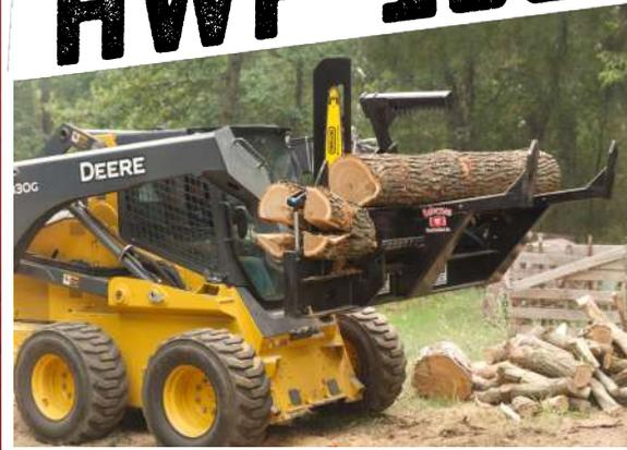
Le HWP-150 est doté d'un coin hydraulique et d'un bras de préhension plus long qui s'ouvre parallèlement à la bûche et la maintient en place. Vous pouvez couper des bûches de 20"-22" et il a plus de force de fendage que le 140B. Le HWP-150 est livré en standard avec la cale à 4 voies, mais la cale à 6 voies est disponible en tant que mise à niveau. Poids: 1638 livres
