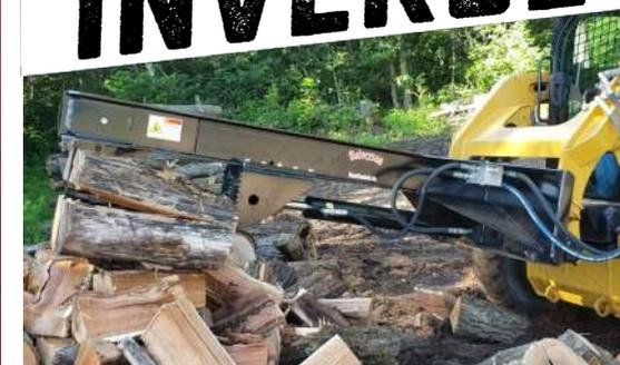
La fendeuse inversé est conçue pour fendre de grosses bûches jusqu'à 29" de longueur et des bûches d'un diamètre trop gros pour passer dans nos processeurs à bois de chauffage. Le fendeur inversé complète notre scie à grappin, car il peut fendre les grosses bûches que la scie à grappin peut couper. Le corps de vanne comprend une vanne à régénération qui réagit très rapidement et accélère le processus de fendage. Il est livré en standard avec un coin de fendage à 4 voies.
