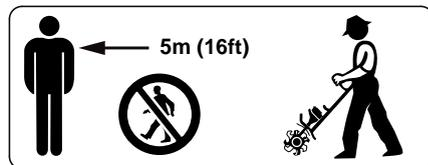
La machine peut projeter des objets à une grande distance de l'aire de travail. C'est pourquoi, à part l'utilisateur, personne ne doit se trouver dans un rayon de 15 m de la machine en marche. Respecter aussi cette distance par rapport à des véhicules, des vitres etc. – **risque de dégâts matériels !** Même à une distance de plus de 15 m, des objets projetés peuvent encore présenter des risques.
