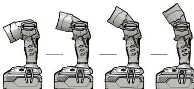
1. Gire el cabezal superior de la máquina para ajustar el ángulo de la luz (0-135°).
