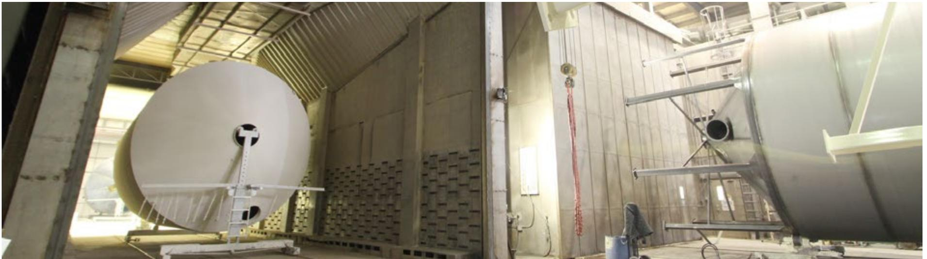
**LA FINITION PAR THERMOLAQUAGE (MPS-1000) MERIDIAN** (MPS-1000) a un indice de salinité de 2 000 heures, soit 3 à 4 fois plus que la norme pour la peinture humide. L'adhérence supérieure et la finition lisse et durable du revêtement en polyester garantissent que les silos à trémie SmoothWall de Meridian seront incroyablement durables et résisteront à l'épreuve du temps. La finition extérieure Meridian est couverte par notre garantie de 5 ans sur la peinture.
