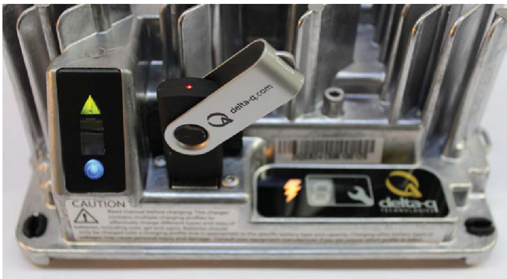
Figura 4: inserte la memoria USB para comenzar el proceso de reprogramación. Al finalizar, el Indicador USB/Error/Falla estará verde como se muestra.
