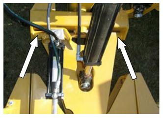
Figure 12. Lift pivot zerks (2).
