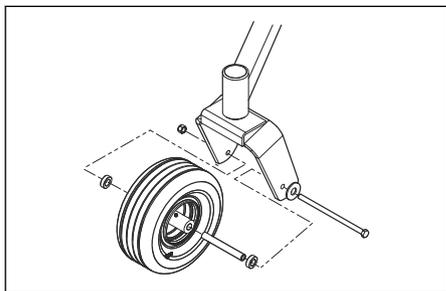
2. Effectuer l'installation dans l'ordre inverse. Serrer le boulon et l'écrou au couple de 67,8 N•m (50 lb•pi).
