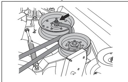
6. Pousser le bras de renvoi pour réduire la tension de la courroie de l'unité de coupe et retirer soigneusement la courroie des poulies.
