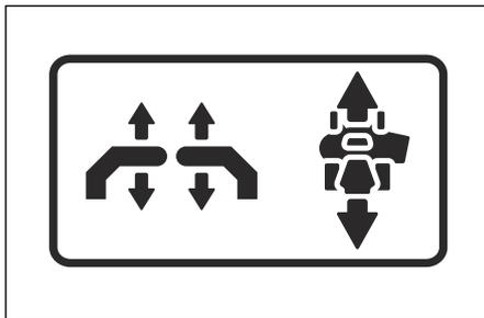
4. Tirer délicatement les deux leviers de commande vers l'arrière. Le produit va commencer à se déplacer vers l'arrière. La vitesse de marche arrière augmente à mesure que les deux leviers de commande sont tirés vers l'arrière.
