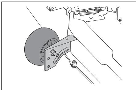
3. Installer le rouleau anti-arrachement dans l'une des trois positions.
