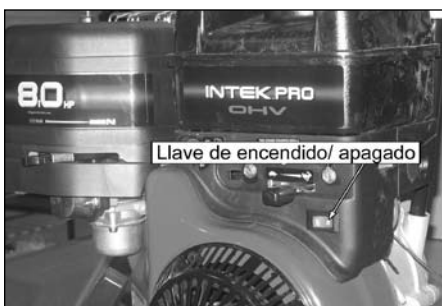
Figure 3.8 Llave Comercial de encendido/apagado Briggs
