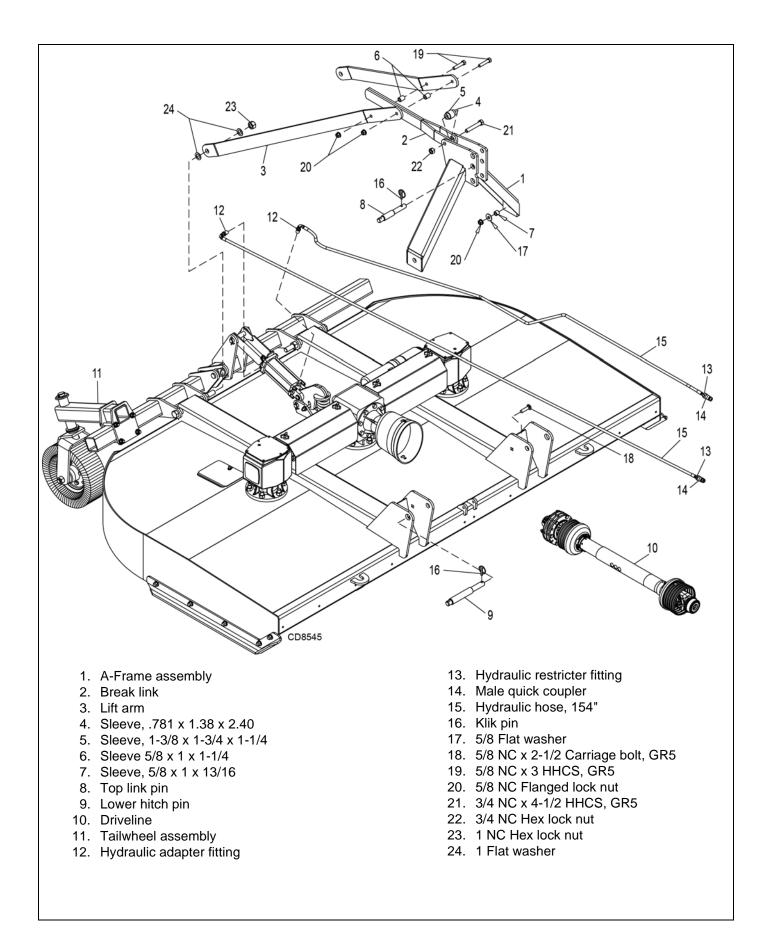
Figure 29. DS8.50 & DS10.50 3-Point Mounted Cutter Assembly
