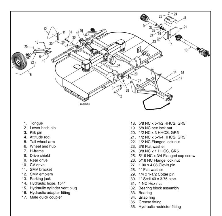
Figure 28. DS8.50 & DS10.50 Pull-Type Cutter Assembly
