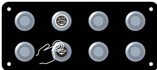
IMPIANTO DI PROSCIUGAMENTO
