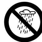
Ne pas travailler avec la machine sous la pluie, à un endroit mouillé ou dans une ambiance très humide – le moteur électrique n'est pas protégé contre la pénétration de l'eau – **risque d'électrocution et de court-circuit !**
