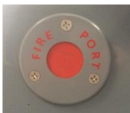
Feuerlöschöffnung auf der Backbordseite der Konsole
