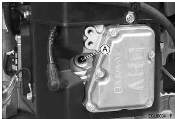
A. Orificio de la bujía de encendido
