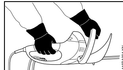
Coloque la mano derecha sobre el mango trasero y la izquierda sobre el mango delantero.
