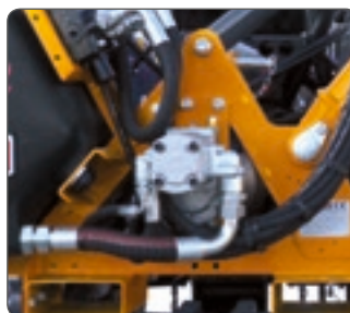
Pompa idraulica azionamento rotore in alluminio. Aluminium rotor drive hydraulic pump.
