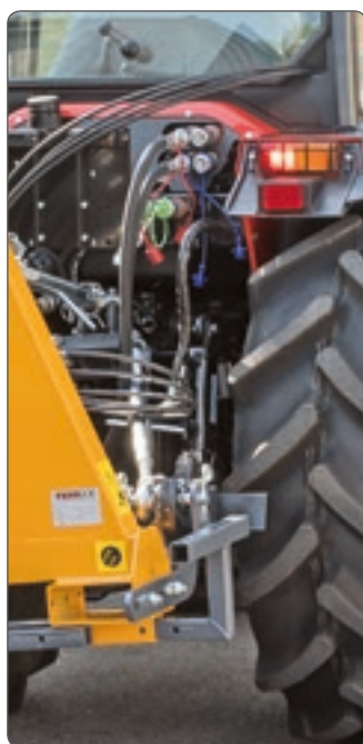
Impianto idraulico dipendente. Dependent hydraulic system.
