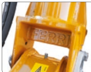
Elementi stampati per le articolazioni dei bracci. Drop forged arm brackets.
