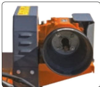
Gruppo moltiplicatore esterno alla trasmissione. Gearbox external to the gear housing.
