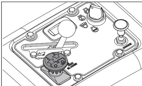
Pour engager les lames de l'unité de coupe, tirer le bouton vers le haut; les lames de la tondeuse sont débrayées lorsque le bouton est enfoncé.
