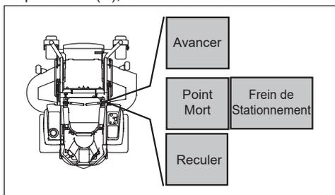
Lorsque les deux leviers sont déplacés vers l'avant ou vers l'arrière de façon similaire, la machine se déplace en ligne droite vers l'avant ou vers l'arrière.
