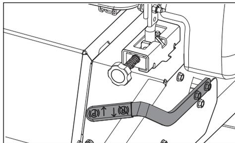
Le frein de stationnement se trouve du côté gauche de la machine. Appuyer sur le bouton de dégagement et tirer le levier vers l'arrière pour serrer le frein; pousser vers l'avant pour le desserrer.
