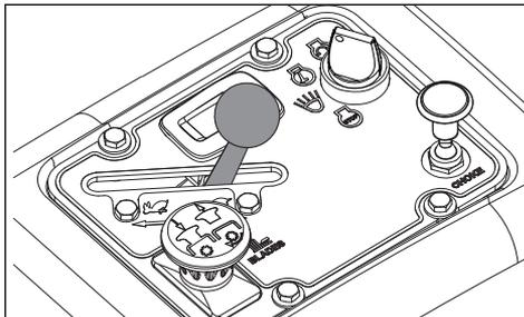
La commande de l'accélération contrôle le régime moteur et, par conséquent, le taux de rotation des lames, en supposant que le levier de commande des lames est tiré. Voir la section « Activation de l'unité de coupe ».
