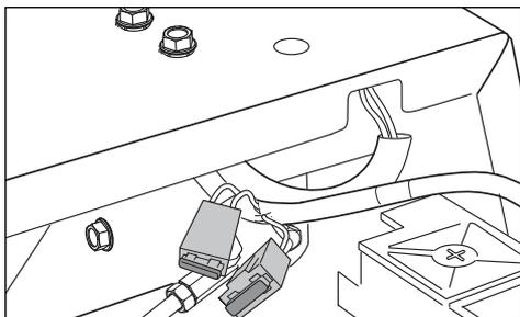
Le fusible principal de 20 A se trouve du côté gauche de la machine. On peut y accéder en faisant basculer le siège vers l'avant. Le fusible est de type plat comme ceux utilisés dans les voitures. Le circuit de 7,5 A sert à l'accouplement de l'unité de coupe à la tondeuse.
