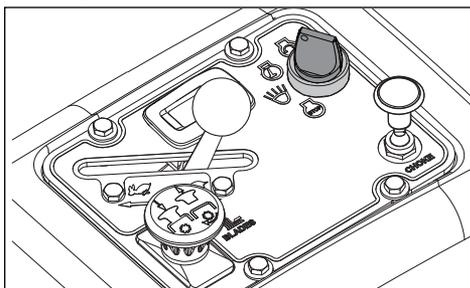
L'interrupteur d'allumage sert à démarrer et à arrêter le moteur. Sur les modèles équipés de phares, tourner la clé dans le sens horaire sur **ACCESSORY (ACCESSOIRE)** pour les utiliser.
