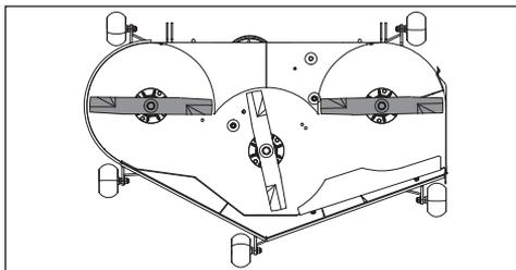
2. Mesurer de la surface du sol jusqu'au bas de la pointe de lame sur le côté de l'éjecteur de l'unité de coupe. Noter cette mesure.
