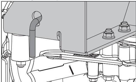
Les tringleries de dérivation entre les axes doivent être engagées lorsque l'on pousse ou tire sur la tondeuse. Les leviers de dégagement se trouvent sur chaque côté à l'arrière de l'unité, en-dessous de la plaque arrière du moteur. Se reporter à la rubrique **Transport manuel** de la section Fonctionnement.
