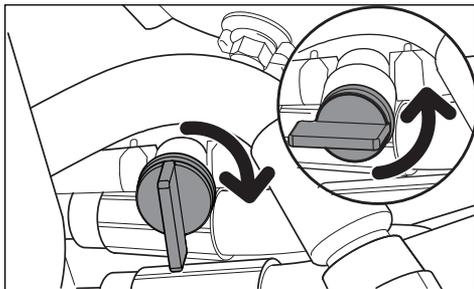
La soupape d'arrêt de carburant se trouve du côté arrière gauche du siège. La valve est fermée lorsque la languette est tournée perpendiculairement à la conduite d'alimentation en carburant.
