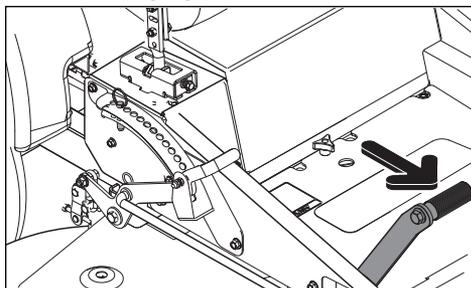
La goupille de réglage de la hauteur permet de régler la hauteur de coupe souhaitée. La pédale de réglage de la hauteur de coupe relâche le dispositif de levage de l'unité de coupe pour placer l'unité de coupe à la hauteur sélectionnée.
