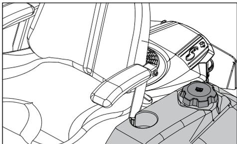
Lire les consignes de sécurité avant d'effectuer un plein de carburant. La machine comporte un réservoir de carburant, situé derrière la console. Le volume du réservoir est de 19 litres (5 gallons). Vérifier régulièrement le joint du bouchon de carburant afin de détecter tout dommage et bien serrer le bouchon.
