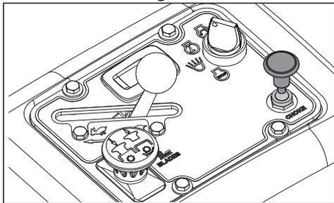
La commande d'étrangleur est utilisée lors des démarrages à froid afin d'enrichir le mélange gazeux. Pour les démarrages à froid, la commande doit être tirée vers le haut.
