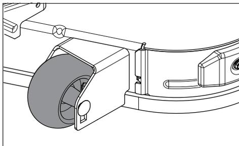
**INFORMATION IMPORTANTE** Régler les roulettes anti-scalp lorsque la tondeuse repose sur une surface plane de niveau. Pour éviter les dommages, il ne faut pas ajuster les roulettes anti-scalp pour soutenir l'unité de coupe.
