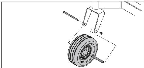
Reposer dans l'ordre inverse de la dépose. Serrer le boulon pivotant. Serrer le boulon de la roulette au couple de 61 N.m (45 pi-lb).
