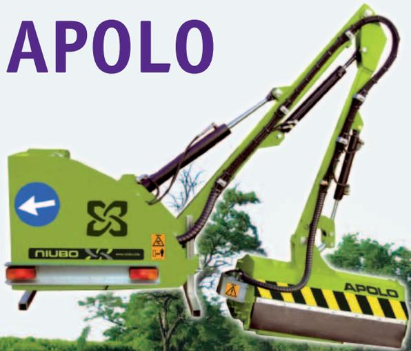
Desbrozadoras hidráulicas para tractores de 40 a 70 CV, idónea para la limpieza de fosos, zanjas y bordes de la vía pública.
